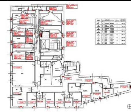
Impianto termico – schema radiatori piano terzo
